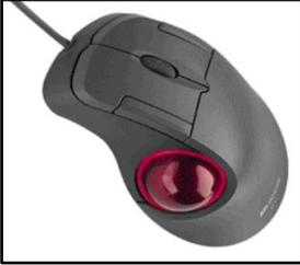
بعض مستخدمي الحاسب لا يحبون الفأرة بسبب المساحة التي تحتاجها لكي تتحرك بها بسهولة فقد تكون المساحة ضيقة فيشعر المستخدم بالضيق وعدم الارتياح ولذلك ظهرت وحدة الإدخال "كرة التتبع" التي يمكن للمستخدم التعامل معها بدوران الكرة فقط بأصابعه دون حركة الوحدة مما يمكن استخدامها في مساحات ضيقة وهذه الوحدة تشبه إلى حد ما الفأرة ولها أزرار تستخدم لتحديد الكائنات وفتحها، وهناك نوع من وحدات الإدخال (Trackball) غالبا ما يتواجد في حاسبات (Laptop) مثبت بها.
