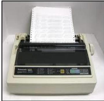
تتميز هذه الطابعة بأنها رخيصة الثمن وسهلة الاستخدام. ويعيب هذه الطابعة أنها قد تحدث بعض الضوضاء أثناء الطباعة ويطلق على هذا النوع من الطابعات اسم الطابعة التصادمية (Impact Printer) حيث أسلوب الطباعة يتم عن طريق الضغط على الحرف. وهناك طابعات أخرى تستخدم رش الحبر أو الحرارة في تكوين الحروف على ورق الطباعة ويطلق على هذا النوع اسم طابعات غير تصادمية (No impact Printers).
