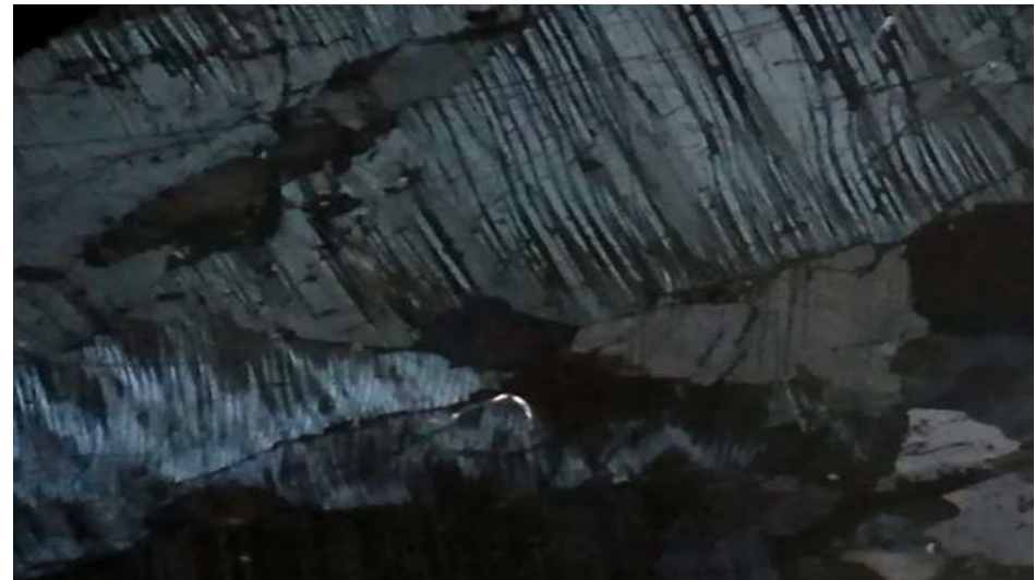
Stibnite : anisotropic mineral : brown to grey shades
