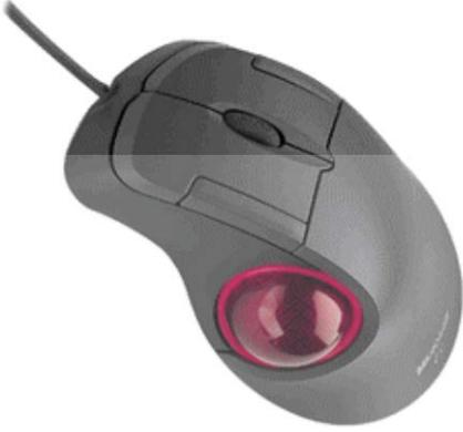
بعض مستخدمي الحاسب لا يحبون الفأرة بسبب المساحة التي تحتاجها لكي تتحرك بها بسهولة فقد تكون المساحة ضيقة فيشعر المستخدم بالضيق وعدم الارتياح ولذلك ظهرت وحدة الإدخال "كرة التتبع" التي يمكن للمستخدم التعامل معها بدوران الكرة فقط بأصابعه دون حركة الوحدة مما يمكن استخدامها في مساحات ضيقة وهذه الوحدة تشبه إلى حد ما الفأرة ولها أزرار تستخدم لتحديد الكائنات وفتحها ، وهناك نوع من وحدات الإدخال (Trackball) غالبا ما يتواجد في حاسبات (Laptop) مثبت بها.
