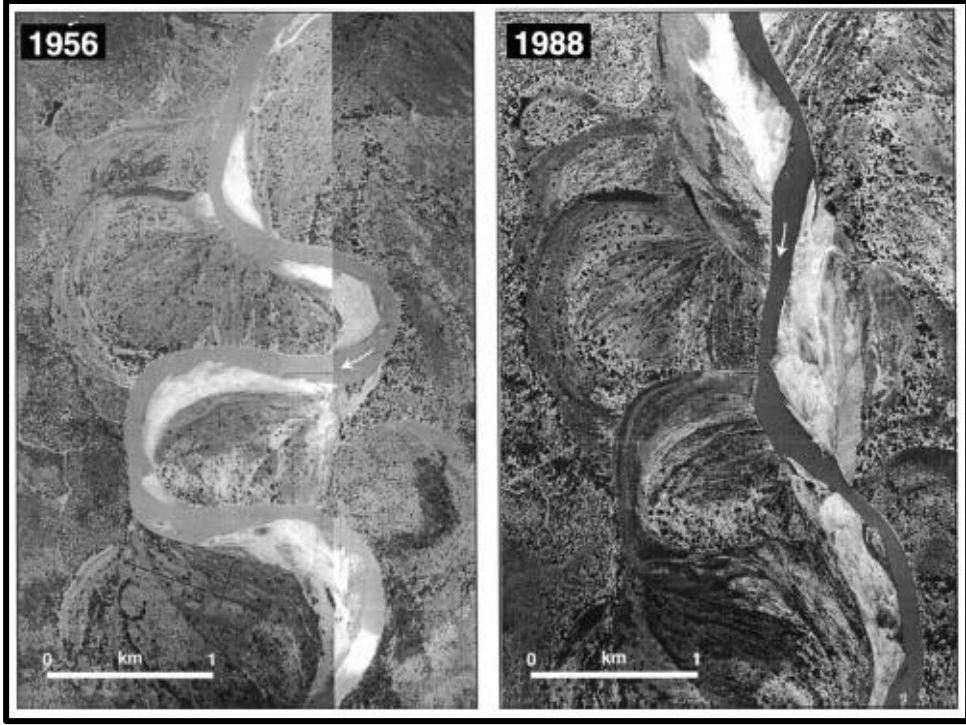
شكل (١٣) تطبيقات التصوير الجوي في دراسة الارساب النهري والتغيرات في المجرى (نهر لوانقوا - زامبيا)
