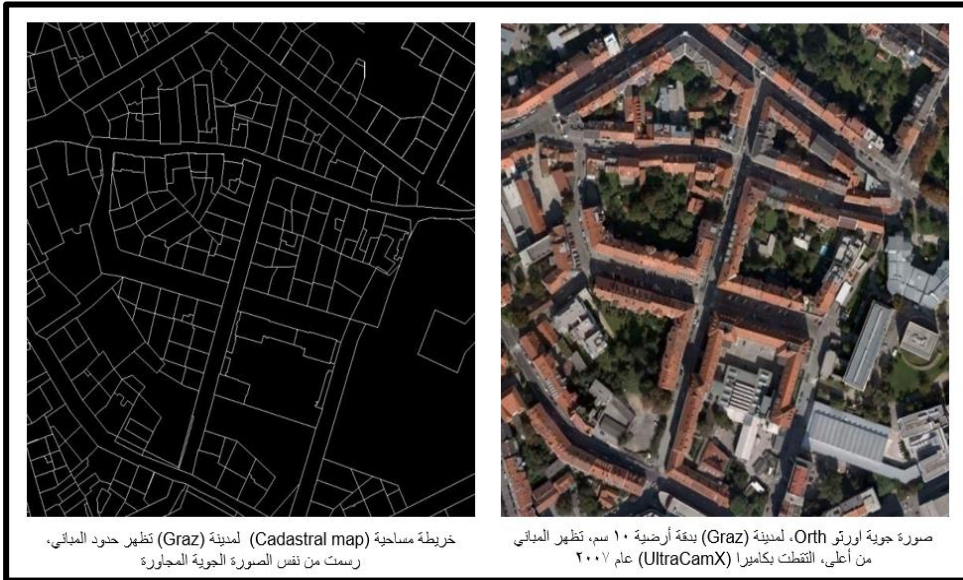
شكل (١٢) طرق رسم المباني من الصور الجوية الرأسية Vertical
