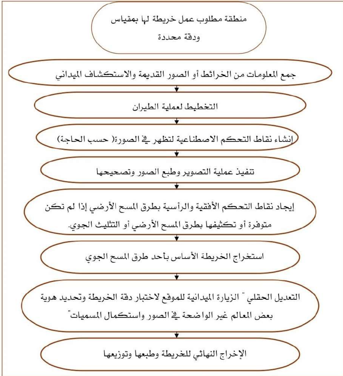
الشكل ١ يوضح المراحل الأساسية لإنتاج الخرائط من الصور الجوية
