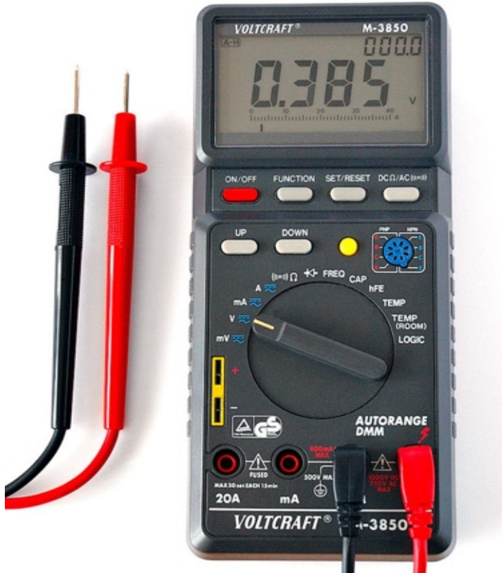
شكل 15: الفولتامتر لقياس الجهد الكهربى
