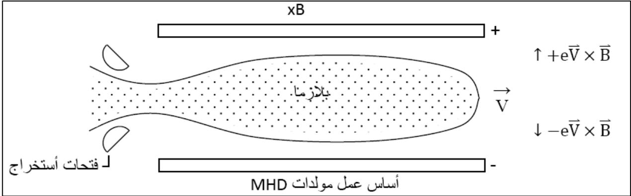
ولتوليد الطاقة الكهربائية في هذا النوع من المولدات نحتاج إلى سرعة عالية للبلازما الداخلة إضافة إلى معامل توصيل كهربائي عالي وكثافة عالية.
