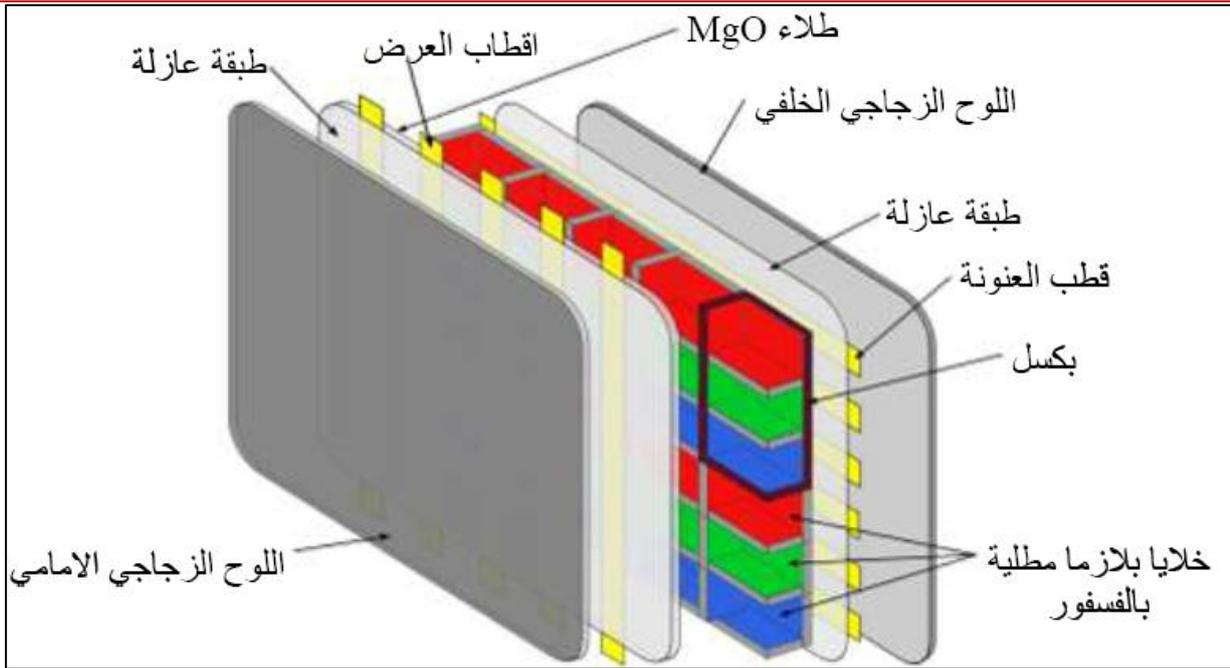
وعملية تأين الغاز في داخل اية خلية ضوئية يتحكم فيه كمبيوتر خاص للشاشة حيث يتحكم في توجيه الشحنة الكهربائية الى الالكترودين المتعامدين فيحدث التفريغ الكهربائي في تلك الخلية وتكرر هذه العملية الاف المرات في جزء من الثانية.
