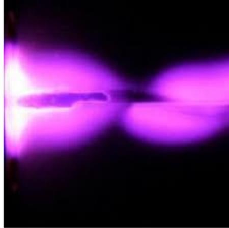
2. التفريغ على شكل الفرشاة: في حالة الجهود العالية يتخذ التفريغ الهالي شكل الفرشاة المضيئة اي مجموعة من متحركة من الخطوط الدقيقة والمضيئة الملتوية، تخرج من الطرف المدب ويسمى مثل هذا التفريغ بالتفريغ على شكل الفرشاة.
