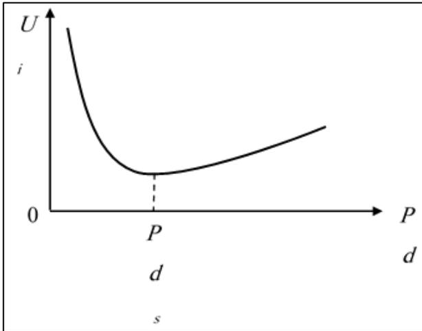
حيث  $d$  المسافة أو البعد بين القطبين و  $\alpha$  معامل التأين الحجمي للغاز بالإلكترونات وهو يساوي متوسط عدد التأينات التي يحدثها الإلكترون الواحد أثناء قطعه مسافة قدرها وحدة طول و  $\gamma$  معامل التأين السطحي وهو يساوي
