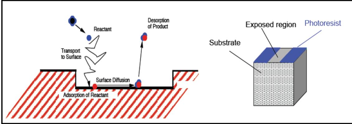
وتستخدم عدة طرق لأجراء عملية الحفر من أهمها الحفر الكيميائي الرطب (Wet chemical etching) والحفر الجاف (Dry etching)
