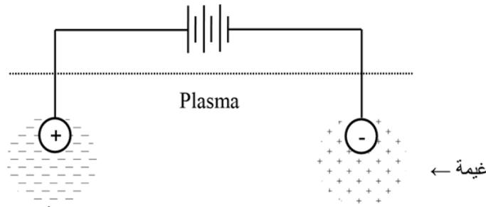
إن كل كرة من الكرات المشحونة سوف تتسبب في تفريق الشحنات المشابهة لها في منطقة المجال المحيط بها في حين تتجاذب مع الشحنات المعاكسة لها. وهذا الفصل في الشحنات سوف يؤدي إلى تغيير شكل المجال في البلازما. فإن أحد المميزات الأساسية في توليد البلازما هي مقدرتها على إختزان أو حجب الجهود الكهربائية التي تتولد فيها.
