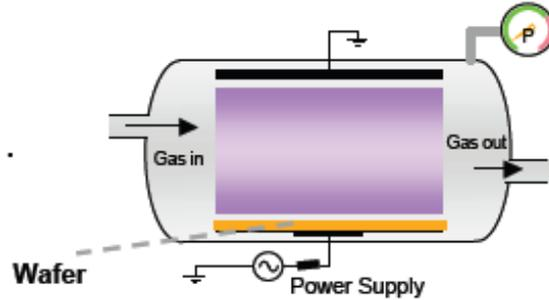
تتم هذه العملية عن طريق ادخال غاز عند ضغط معين الى حجرة التفاعل (Chamber) ويتم تسليط فرق جهد بين الاقطاب مما يؤدي الى حدوث تفريغ توهجي للغاز، تتولد اصناف عديدة من الجسيمات في محيط البلازما مثل (الايونات، الالكترونات، الفوتونات، الجذور الحرة، المتعادلات).
