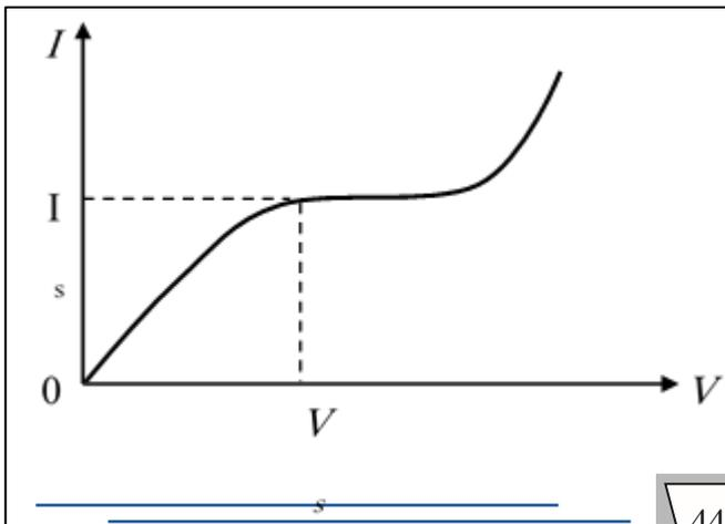
وتتولد الشحنات الكهربائية الحرة اللازمة لإستمرار مثل هذا التفريغ بشكل أساسي نتيجة للتأين التصادمي لجزيئات الغاز بفعل
