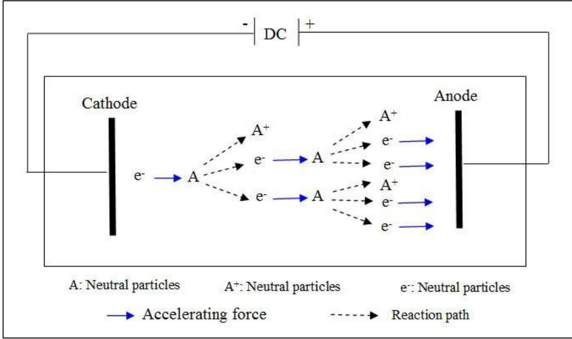
إن أقصى قيمة ممكنة لشدة التيار  $I_s$  عند كل شدة تيار معينة يسمى تيار الاشباع، وهذه في الحالة التي تصل فيها جميع الأيونات المتولدة من الغاز إلى الأقطاب.
