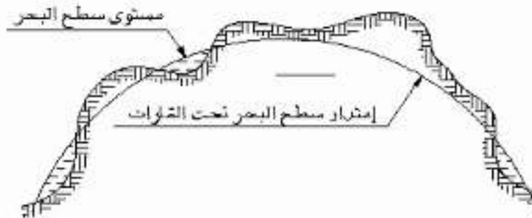
الشكل ١،٥ : يبين سطح البحر كمنسوب لسطح المقارنة.
