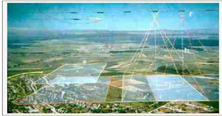
الشكل: ٤ - ١- الأسلوب المتبع في عملية التصوير الجوي
