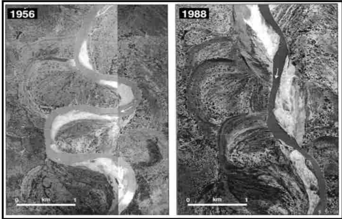
شكل (١٣) تطبيقات التصوير الجوي في دراسة الأرساب النهري والتغيرات في المجرى (نهر لوانقوا - زامبيا)
