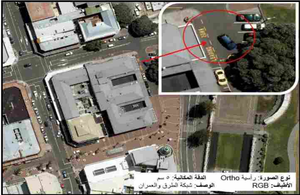
شكل (٩) دقة الصور الجوية في توضيح معالم سطح الأرض وإشارات الطرق
