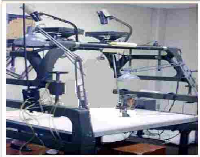
الشكل: ٥- ٣- جهاز رسم تجسيمي بنظام إسقاط ضوئي مباشر (الكيلش)
