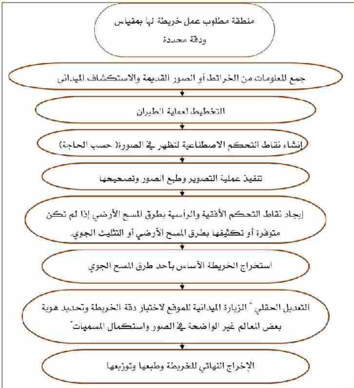
الشكل أ يوضح المراحل الأساسية لإنتاج الخرائط من الصور الجوية
