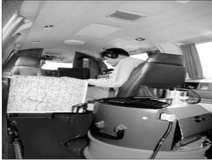
شكل ٦-٢: أحد كاميرات التصوير الجوي مثبتة في قاعدة الطائرة.
