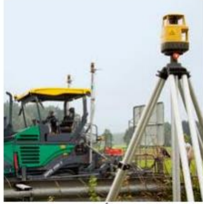
جهاز تسوية الأرض بالليزر
