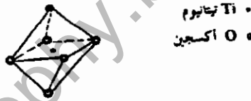
الشكل رقم (٥, ٣). الشكل البلوري لأكسيد التيتانيوم الرباعي.
