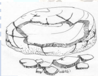
تجمد المياه داخل الشقوق
