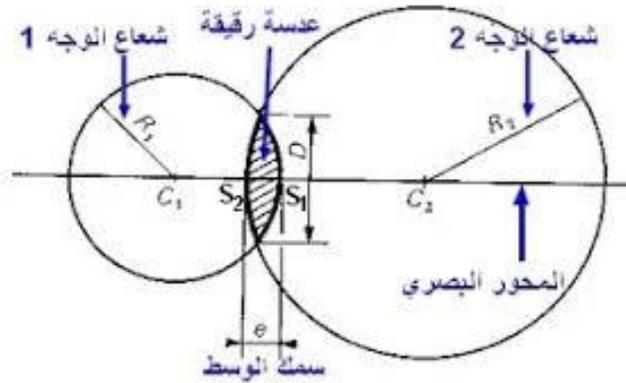
قوة السطح الأول  $F_1$  هي  $F_1 = R_1 (\mu_1 - \mu_2)$  وقوة السطح الثاني  $F_2$  هي  $F_2 = R_2 (\mu_1 - \mu_2)$
