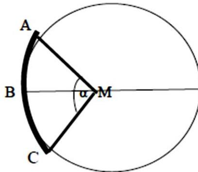
و يسمى قطر دائرة تقاطع الكرة بالمستوى بالاتساع الخطى للمرآة، أما الاتساع الزاوى فتقدر قيمته بمقدار الزاوية  $\alpha$  كما بالشكل. و يسمى المستقيم الواصل بين قطب المرآة B و مركز تكورها M بالمحور الرئيسى للمرآة.
