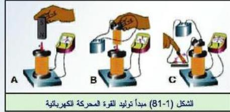
الشكل (1-81) مبدأ توليد القوة المحركة للكهربائية
