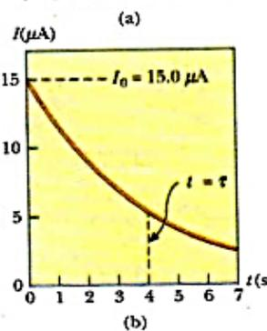
شكل 20.25 رسم يوضح (a) تغير الشحنة مع الزمن و (b) تغير التيار مع الزمن لدائرة RC موضحة بالشكل 19.25 حيث  $R = 8 \times 10^5\ \Omega$ ،  $\mathcal{E} = 12\text{V}$  و  $C = 5\ \mu\text{F}$ .
