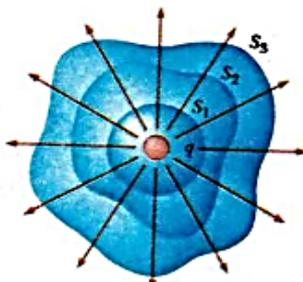
شكل 7.21 : أسطح مغلقة مختلفة الأشكال تحيط بالشحنة  $q$ . الفيض الكهربائي النهائي متساوي لكل الأسطح.
