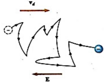
شكل 3.24 رسم تخطيطي للحركة في خطوط منكسرة (Zigzag Motion) للإلكترون داخل موصل. التغير في الاتجاه نتج عن تصادمات بين الإلكترون وذرات الموصل. لاحظ أن الحركة النهائية للإلكترون تعاكس اتجاه المجال الكهربائي. وكل خط من الخطوط المنكسرة يمثل جزء من قطع ناقص.
