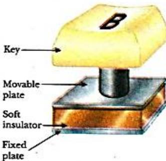
شكل 4.23 أحد أنواع مفاتيح من لوحة مفاتيح الكمبيوتر Keyboard Button
