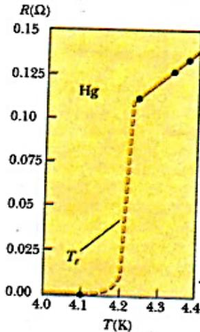
شكل 12.24 العلاقة بين المقاومة ودرجة الحرارة للزئبق (Hg). يتبع المنحنى سلوك الفلز العادي فوق درجة الحرارة الحرجة  $T_c$ . وتهبط فجأة المقاومة النوعية عند  $T_c$  وهي للزئبق 4.2K.
