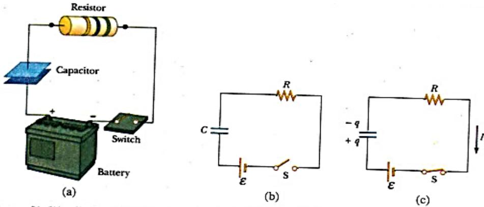
شكل 16.25 (a) يتصل مكثف على التوالي مع مقاومة وبطارية. (b) رسم توضيحي للدائرة المكونة من هذه العناصر عند زمن  $t < 0$ ، قبل غلق المفتاح. (c) رسم للدائرة عند  $t > 0$ ، بعد غلق المفتاح.
