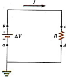
إذا استخدمت بطارية لإحداث تيار كهربائي في موصل، تتحول الطاقة الكيميائية المخزنة في البطارية بشكل متصل إلى طاقة حركية لحاملات الشحنة. في الموصل، سريعاً ما تفقد هذه الطاقة الحركية نتيجة التصادم بين حاملات الشحنة والذرات التي تمثل الموصل، ويؤدي ذلك إلى زيادة درجة حرارة الموصل. وبتعبير آخر، تتحول الطاقة الكيميائية المخزنة في البطارية باستمرار إلى طاقة داخلية مصحوبة بزيادة في حرارة الموصل.
