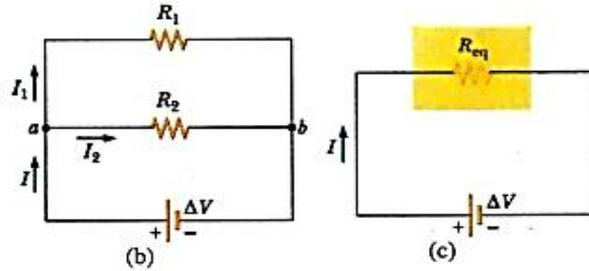
شكل 5.25 (a) توصيل مقاومتين  $R_1$  و  $R_2$  على التوازي. فرق الجهد خلال  $R_1$  يساوي فرق الجهد خلال  $R_2$ . (b) رسماً لدائرة المقاومتين. (c) تم استبدال المقاومات بمقاومة مكافئة واحدة  $R_{eq} = (R_1^{-1} + R_2^{-1})^{-1}$ .
