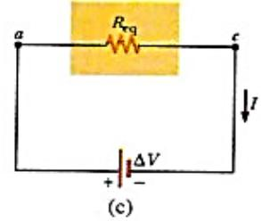
شكل 4.25 (a) التوصيل على التوالي لمقاومتين  $R_1$  و  $R_2$ . يكون التيار في  $R_1$  مساوياً لقيمته في  $R_2$ . (b) رسم للدائرة المحتوية للمقاومتين. (c) استبدلت المقاومتين بمقاومة واحدة تسمى المقاومة المكافئة وقيمتها  $R_{eq} = R_1 + R_2$ .
