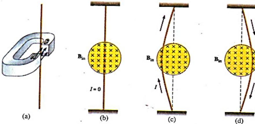
شكل 6.26 (a) سلك معلق رأسياً بين قطبي مغناطيس. (b) الجزء (a) كما يرى بالنظر للقطب الجنوبي للمغناطيس، بحيث يتجه المجال المغناطيسي (العلامات الزرقاء) ناحية الصفحة. عندما لا يحمل السلك تياراً يظل عمودياً. (c) عندما يكون التيار لأعلى، ينحرف السلك لليسار. (d) وعندما يكون التيار لأسفل ينحرف السلك لليمين.
