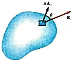
شكل 3.21: عنصر صغير للمساحة  $\Delta A_i$ . المجال الكهربائي يصنع زاوية  $\theta$  مع المتجه  $\Delta A_i$ ، والذي يعرف بأنه العمودي على عنصر المساحة، ويكون الفيض الكهربائي خلال العنصر مساوياً  $E_i \Delta A_i \cos \theta$
