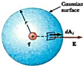
شكل 6.21 : سطح جاوس كروي نصف قطره  $r$  يحيط بشحنة نقطية  $q$ . عندما تكون الشحنة في مركز الكرة، يكون المجال الكهربائي عمودياً على أي نقطة على السطح ومقداره ثابت.
