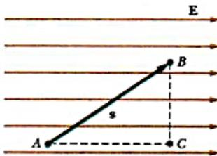
شكل 2.22 : مجال كهربائي منتظم يتجه خلال الاتجاه الموجب للمحور  $x$ . النقطة  $B$  جهدهما الكهربائي أقل من الجهد الكهربائي للنقطة  $A$ . النقطة  $B$  و  $C$  عند نفس الجهد الكهربائي.
