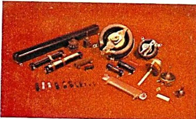
مجموعة متنوعة من المقاومات تستخدم في الدوائر الكهربائية .
