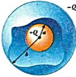
شكل 6.23 مكثف كروي يتكون من كرة داخلية نصف قطرها  $a$  محاطة بقشرة كروية متحدة معها في المركز ونصف قطرها  $b$ . ويتجه المجال الكهربائي بين الكرتين في اتجاه نصف القطر للخارج عندما تكون الكرة الداخلية موجبة الشحنة.
