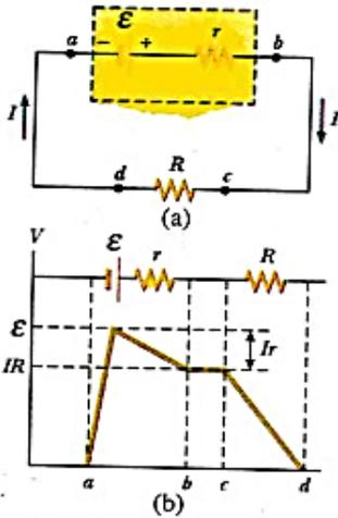
شكل 2.25 (a) رسم تخطيطي لدائرة مصدر ق. د. ك (في هذه الحالة بطارية) مقاومتها الداخلية  $r$ ، متصلة بمقاومة خارجية  $R$ . (b) رسم بياني يوضح كيفية تغير الجهد الكهربائي بتغير الموضع في اتجاه عقرب الساعة في الجزء (a).
