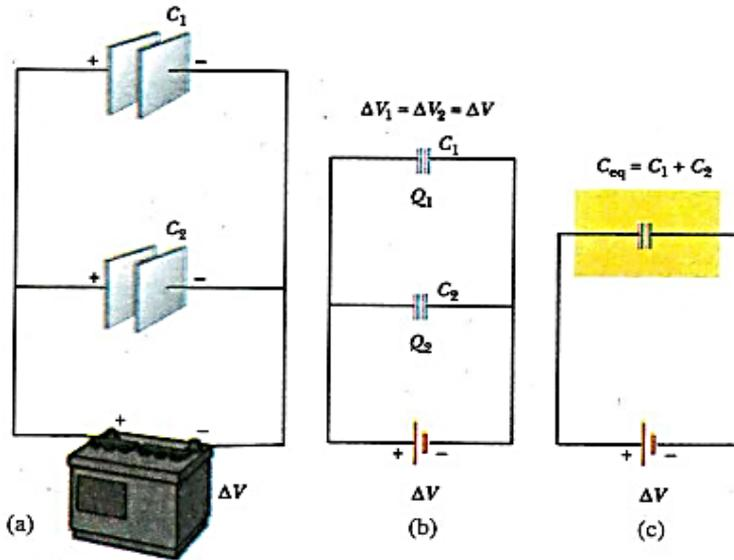
شكل 8.23 (a) مجموعة مكونة من مكثفين متصلان على التوازي في دائرة كهربائية فرق الجهد بين قطبيها هو  $\Delta V$ . (b) رسماً لدائرة التوصيل على التوازي. (c) السعة المكافئة هي  $C_{eq} = C_1 + C_2$ .
