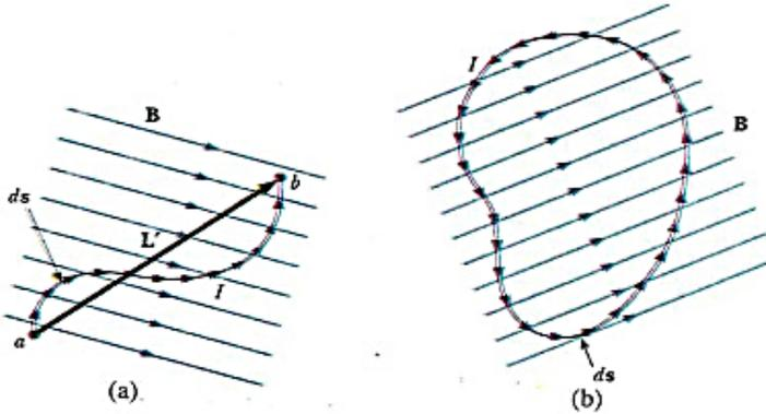
شكل 9.26 (a) سلك منحنى يحمل تيار  $I$  في مجال مغناطيسي منتظم. القوة المغناطيسية الكلية المؤثرة على السلك تكافئ القوة على سلك مستقيم طوله  $L'$  يصل بين نهايتي السلك المنحني. (b) التيار المار في دائرة مغلقة ذات شكل اختياري في مجال مغناطيسي منتظم. وتكون القوة الكلية في الدائرة مساوية للصفر.
