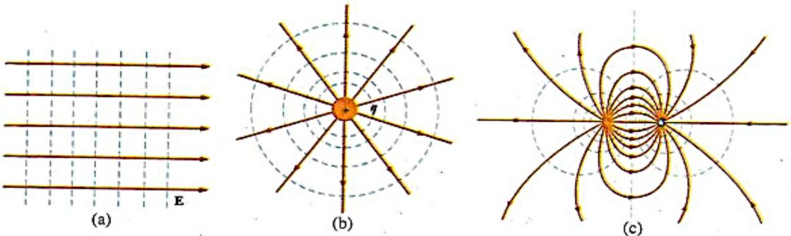
شكل 12.22 أسطح تساوي الجهد (الخطوط الزرقاء المتقطعة) وخطوط المجال الكهربائي (الخطوط الحمراء) لكل من (a) مجال كهربائي متجانس ناشئ عن شريحة لا نهائية مشحونة (b) شحنة نقطية، (c) ثنائي قطب كهربائي. في جميع الحالات، أسطح تساوي الجهد تتعامد على خطوط المجال الكهربائي عند كل نقطة. قارن هذه الرسوم مع الأشكال 2.22، 7.22b و 8.22b.
