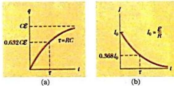
شكل 17.25 (a) رسم يوضح تغير الشحنة مع الزمن أثناء شحن المكثف في الدائرة الموضحة بشكل 16.25. بعد مرور فترة زمنية  $\tau$ ، تصل الشحنة إلى 63.2% من قيمتها العظمى  $C\mathcal{E}$ . وتصل الشحنة إلى قيمتها العظمى عند  $t=\infty$ . (b) رسم يوضح تغير التيار مع الزمن للدائرة الموضحة بشكل 16.25. يصل التيار إلى قيمته العظمى  $I_0 = \mathcal{E}/R$  عند  $t=0$  ويصل إلى الصفر أسياً عندما تكون  $t=\infty$ . وبعد مرور زمن قدره  $\tau$  تصل قيمة التيار إلى 36.8% من قيمته الابتدائية.
