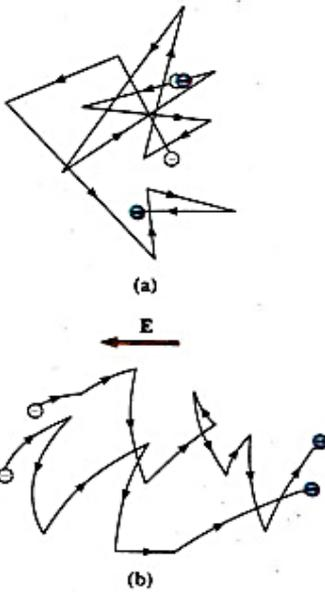
شكل 9.24 (a) رسم تخطيطي للحركة العشوائية لإثنين من حاملات الشحنة في موصل عند عدم وجود مجال كهربائي. تكون سرعة التدفق مساوية للصفر. (b) حركة حاملات الشحنة في موصل في وجود مجال كهربائي. لاحظ أن الحركة العشوائية تتعدل نتيجة وجود المجال الكهربائي وتكتسب حاملات الشحنة سرعة تدفق.
