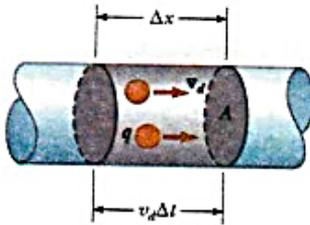
يمكننا ربط التيار بحركة ناقلات الشحنة وذلك بوصف نموذج دقيق للتوصيل في المعادن. إفرض أن التيار يسري في موصل مساحة مقطعه  $A$  (شكل 2.24). حجم جزء في الموصل طوله  $\Delta x$  (المنطقة الرمادية في الشكل 2.24) هو  $A \Delta x$ . إذا كانت  $n$  تمثل عدد ناقلات الشحنة المتحركة لوحدة الحجم (بعبارة أخرى، كثافة ناقلات الشحنة)، يكون عدد ناقلات الشحنة في المنطقة الرمادية هو  $nA\Delta x$ . لذلك تكون الشحنة  $\Delta Q$  في هذا الجزء هي
