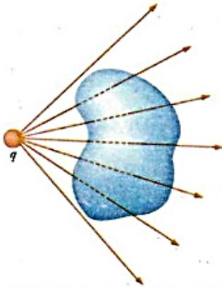
شكل 8.21: تقع شحنة نقطية خارج سطح مغلق. ويكون عدد خطوط المجال الكهربائي الداخلة للسطح مساوياً لعدد الخطوط الخارجة من السطح.
