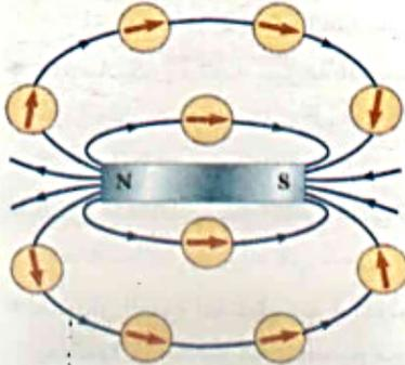
شكل 1.26 إبرة مغناطيسية تستخدم لتتبع خطوط المجال المغناطيسي لساق ممغنطة.
