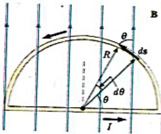
شي سلك ليمثل نصف دائرة مغلقة نصف قطرها  $R$  وتحمل تيار  $I$ . يقع السلك في المستوى  $xy$  ويتجه المجال المغناطيسي المنتظم في اتجاه موجب  $z$  كما بالشكل 10.26. أوجد مقدار واتجاه القوة المغناطيسية المؤثرة على الجزء المستقيم من السلك وعلى الجزء المنحني.
