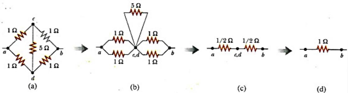
**شكل 8.25** بسبب التماثل في الدائرة، المقاومة  $5\Omega$  لا تساهم في المقاومة بين النقطتين a و b وعلى ذلك يمكن غرض النظر عن وجودها عند حساب المقاومة المكافئة.
