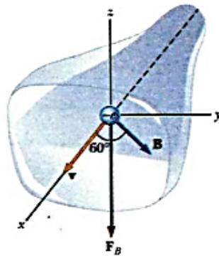
شكل 5.26 القوة المغناطيسية  $F_B$  التي تؤثر على إلكترون في اتجاه سالب  $z$  عندما تقع  $v$  و  $B$  في المستوى  $xy$ .
