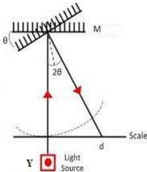
يستخدم الجلفانومتر ذو المرآة في القياسات الدقيقة للتيار الكهربائي وفيه يستبدل المؤشر بمرآة صغيرة  $M$  تتصل بالملف المتحرك او على وجه العموم بالجزء المتحرك في الجلفانومتر فاذا سقط على المرآة شعاع ضوئي من المصدر  $Y$  في الاتجاه العمودي عليها فانه ينعكس منطبقا على اتجاه سقوطه الى مقياس مدرج (نصف شفاف).
