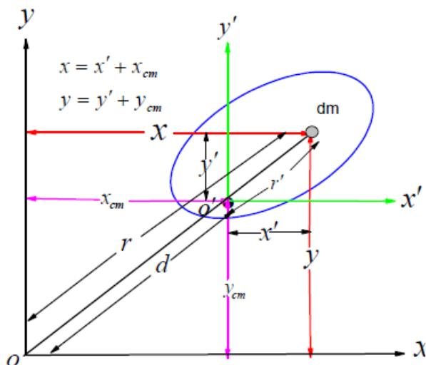
بأخذ عنصر صغير كتلته  $dm$  أحداهيا هذا العنصر بالنسبة للنقطة  $o$  هو  $(x, y)$  وبالنسبة لمركز الثقل  $cm$  هو  $(x', y')$ . بالنسبة للمحورين  $ox, oy$  يعطى حاصل ضرب القصور الذاتي لكتلته  $dm$  بالصورة
