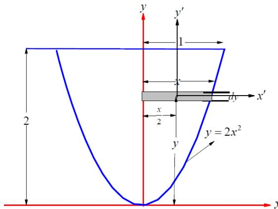
بأخذ الصفيحة كما بالشكل المقابل وبأخذ عنصر صغير هيئة مستطيل صغير طوله  $x$  وعرضة  $dy$  وعلى بعد  $y$  من المحور  $ox$  وبفرض ان كثافة المادة المصنوعة منها الصفيحة هي  $\rho$  . فتعطى كتلته هذا العنصر ( $dm$ ) بالصورة  $dm = \rho x dy$  تكون الكتلة الكلية للصفيحة المثلثية بالصورة
