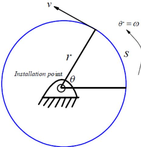
وكانت الحركة بسرعة زاوية مقدارها ( $\omega = \theta^\circ$ ). و يمكننا ايجاد السرعة الخطية المقابلة بالصورة
