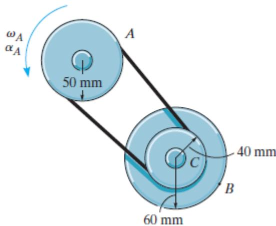
(3)- اذا علمت ان اجزاء المجموعة المبينة بالشكل المقابل تتحرك بعجلة منتظمة وانها بدأت الحركة من السكون و انه عندما كانت  $t = 4 \text{ sec}$ , كانت سرعة الجسم  $A$  هي  $4.8 \text{ m/sec}$  عين سرعة وعجلة كل من الترس  $(B)$  و الترس  $C$  مقدارا واتجاههاً وعدد دورات كل منهم عند  $t = 4 \text{ sec}$ ؟
