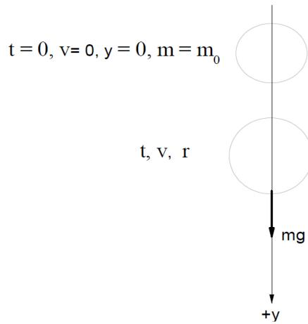
بفرض أن  $m$  هي كتلته القطرة وحيث أن بخار الماء ينكافئ عليها بمعدل كتلي ثابت مقداره  $k$  أي أن وزنها
