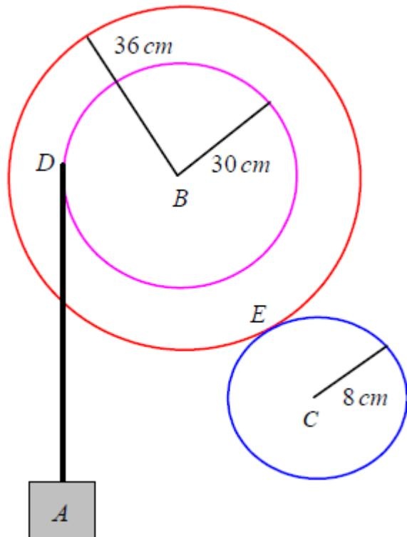
(4)- بكرة نصف قطرها ( $0.3\text{ m}$ ) قابلة للدوران حول محورها ( $O$ ) ملفوف على محيطها خيط غير مرن في نهايته جسيم ( $A$ ). بحيث تدور البكرة حول محور ثابت ( $O$ ) كما بالشكل. اذا تحرك الجسيم ( $A$ ) بسرعة ( $v_A = 0.9 \text{ m/sec}$ ). وكانت عجلة النقطة ( $Q$ ) تميل بزاوية ( $60^\circ$ ) مع الأفقي. اوجد السرعة الزاوية وكذلك العجلة الزاوية للبكرة وأوجد كذلك السرعة الزاوية وكذلك العجلة الزاوية للنقطة ( $Q$ ) التي تقع على البكرة ؟
