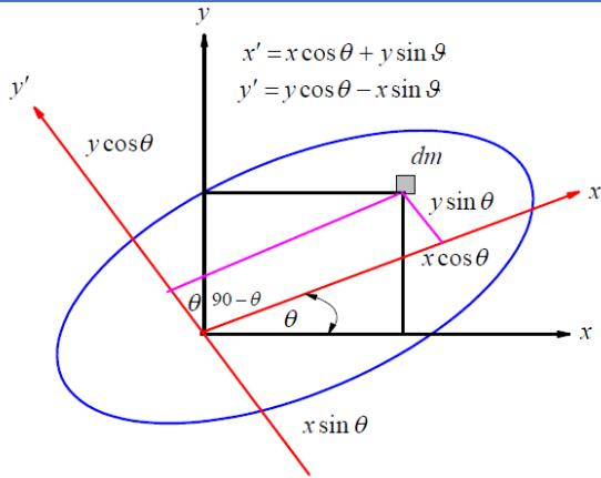
بأخذ عنصر صغير كتلته  $dm$  أحادي هذا العنصر بالنسبة للمحورين  $ox, oy$  هو  $(x, y)$  و بالنسبة للمحورين  $x', y'$  هو  $(x', y')$ . بالنسبة للمحور  $oy'$  يعطى عزم القصور الذاتي لكتلته  $dm$
