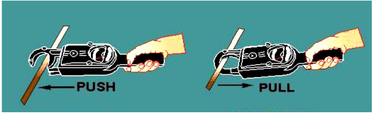
الشكل 10-3 : محول التيار ذو قلب الحديدي المشطور مزود بأميتر
