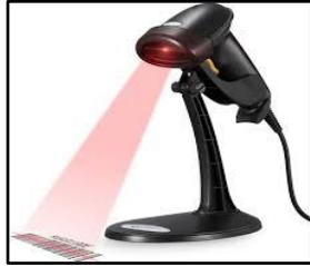
يستخدم في قراءة الكود الموجود على السلع، ومن المعروف أن الماسح الضوئي يقوم بقراءة ما يتم مسحه من صور أو نصوص أو رموز وإدخاله إلى الحاسب في شكل واحد هو صور نقطية (Bitmap Image) أفلكي تتمكن من قراءة النصوص الممسوحة من خلال الماسح الضوئي كنصوص وليست صور نقطية هناك بعض البرامج الجاهزة التي تقوم بترجمة هذه الصور إلى نصوص منها:
