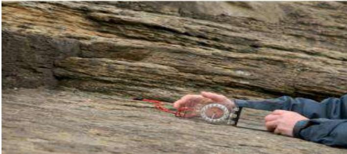
ضع الحافة الطويلة التي هي عند قاعدة تدرج مقياس الميل على مستوي التطبيق، بالتوازي مع الحافة الطويلة للبوصلة - مقياس الميل بحيث يمكنك تخمين أقصى اتجاه للميل (أي توجيه نحو أسفل المنحدر). بينما تنتظر إلى قراءة مقياس الميل، أدر بعناية جهاز البوصلة - مقياس الميل قليلاً (كما موضح من خلال الأسهم) لإيجاد خط الميل الأقصى.
