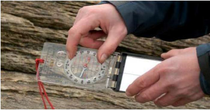
هياً البوصلة - مقياس الميل لوضعية مقياس الميل عن طريق وضع الجزء العلوي من مقياس الميل بحيث يكون موازياً للحافة الطويلة للبوصلة - مقياس الميل (أي وضع قرص البوصلة المدرج على 90 - 270 درجة).
