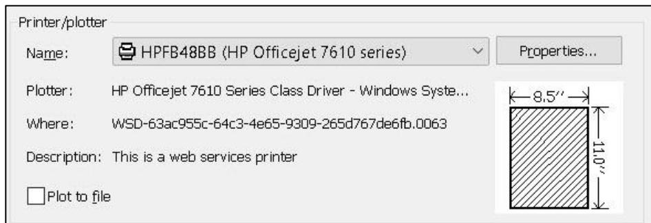
يستخدم لتحديد ابعاد صفحة الطباعة (حجم الورق) المراد الطباعة عليه، نضغط على سهم قائمة الاختيار (Paper Size) فتظهر لنا جميع المقاسات المتاحة، نختار مقاس حجم الورق المناسب (A3، A4،.....) للطابعات الصغيرة او نختار (A0) للرسامات الكبيرة، وبذلك يكون اختيار مقاس الورقة حسب ما يتوافق مع نوع الطابعة او الراسمة لدينا.
