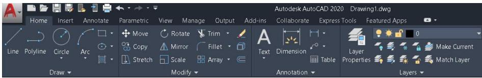
ويمكنا التنقل بين تبويبات شريط (Ribbon) باستخدام لوحة المفاتيح وذلك بالضغط على مفتاح (Alt) من لوحة المفاتيح فيظهر لنا حرف اختصار اسفل كل تبويب وب مجرد الضغط من لوحة المفاتيح على اختصار اي تبويب يمكننا فتح اي من هذه اللوحات:
