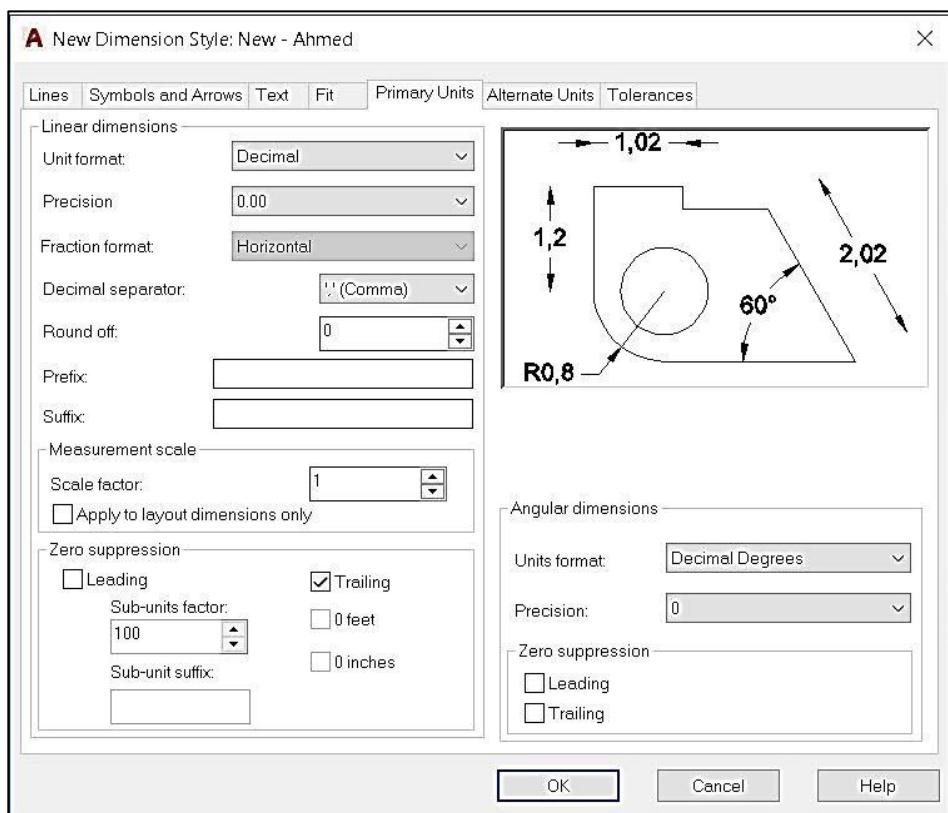
من المجموعة (Unit Format) على نضبط الخيار (Liner Dimensions). ثم نضبط الخيار (Decimal) التي تستخدم للقياسات المترية. ثم نضبط الخيار (Precision) على القيمة (0.0)، وهو عدد المنازل العشرية بعد الفاصلة. أما الخيار (Decimal Separator) يحدد لنا شكل رمز الفاصلة العشرية.
