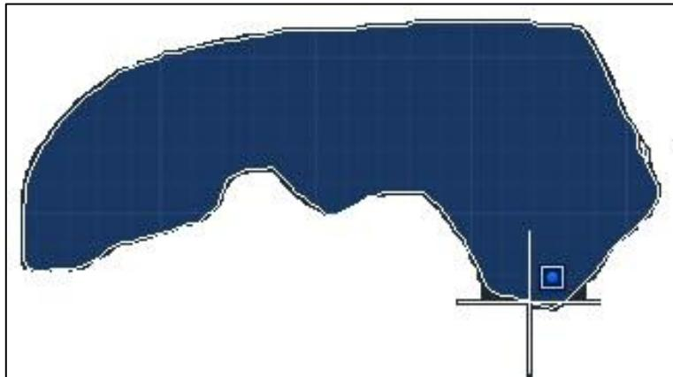
نستطيع كذلك تحديد جميع العناصر الواقعة في لوحة الرسم عن طريق لوحة المفاتيح بالضغط على مفتاحي (Ctrl+A) سيتم تحديد جميع العناصر الموجودة على الشاشة.
