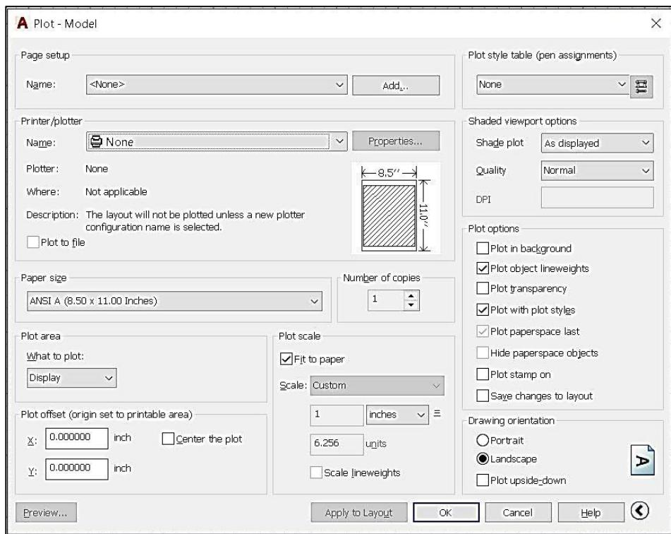
عن طريق تحديد ابعاد الصفحة ومقياس الرسم الذي نريد طباعة اللوحة به، وتحديد توجيه لوحة الرسم بالنسبة الى صفحة الطياعة والعديد من المتغيرات الأخرى التي سوف نتعرف عليها:
