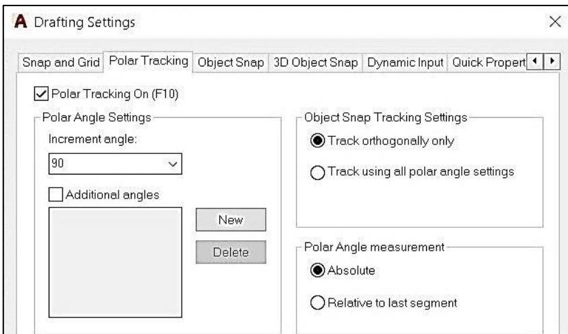
نضبط قيمة الزاوية في الحقل (Increment Angle) (60) ولتكن (60) ثم ننشط الخيار (Polar Tracking On), ثم ننقر زر موافق لغلق مربع الحوار.
