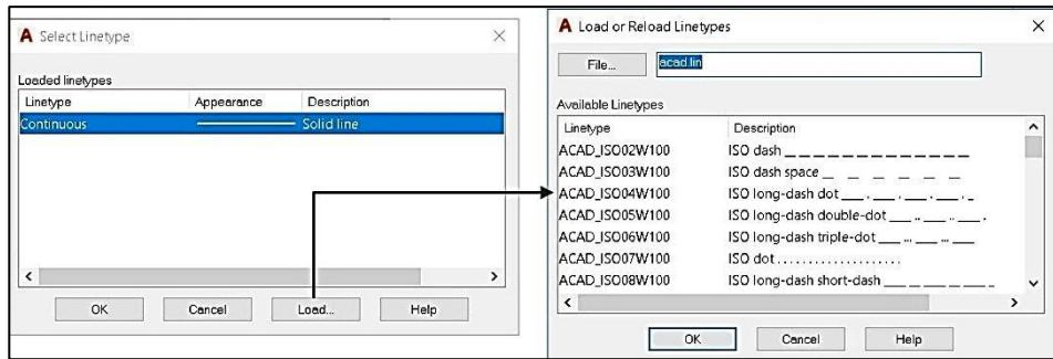
وبعد اختيار نوع الخط المناسب نضغط على الزر (ok) ثم (ok) مرة اخرى. فيتغير نوع الخط الى النوع المختار.
