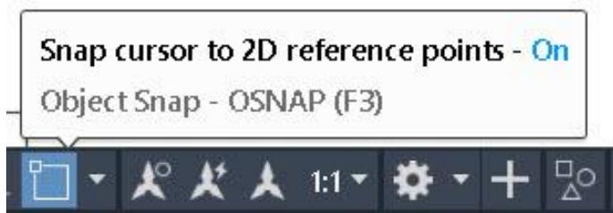
فيظهر لنا مربع حوار (Object Snap) ومن تبويب (Drafting Setting) سنجد امامنا كل الطرق الممكنة للتقاط النقاط، وبجانب كل طريقة رمز لها وهذا الرمز هو الشكل الذي سيظهر في منطقة الرسم على العنصر المطلوب عند الاقتراب منه:
