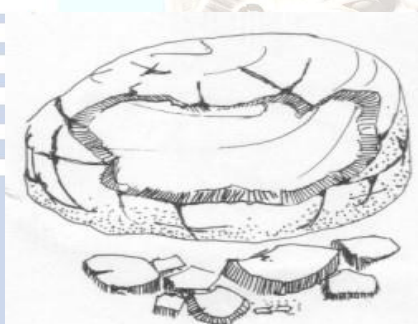
تجمد المياه داخل الشقوق
