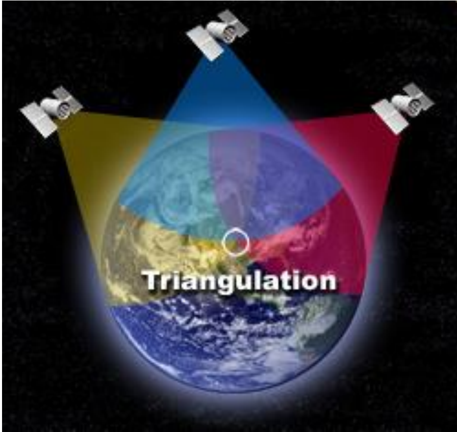
شكل (٣٥) يوضح علاقة إشارات أقمار (GPS) بعملية التثليث
